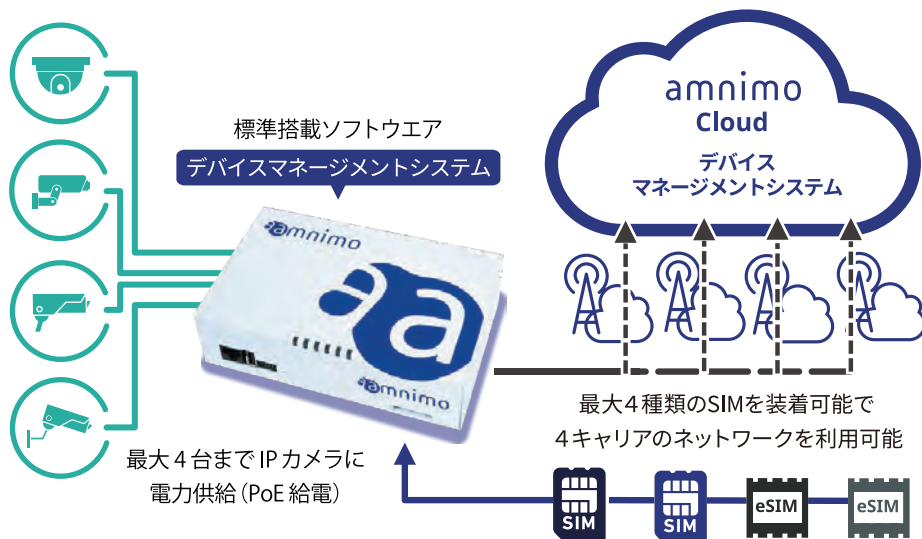
図1. 最大4台のIPカメラを接続し、EthernetやLTEを通じて映像をクラウドに送出することができる、アムニモの「Edge Gateway amnimo G シリーズ AG10」
