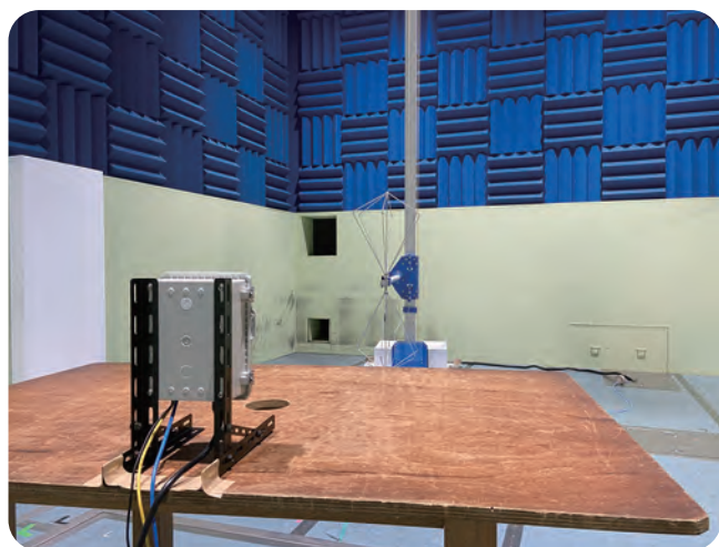
図2：放射エミッション試験の実施環境
