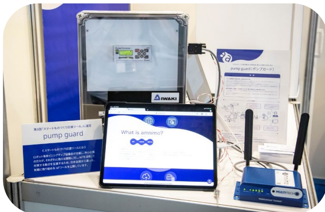
pump guard (うずまきポンプの異常動作を遠隔監視)
